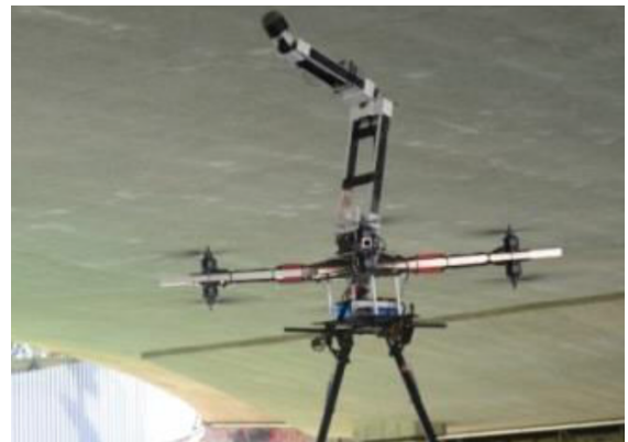
(D) An UAVMS for infrastructure inspection (Jiminez-Cano et al., 2015)
