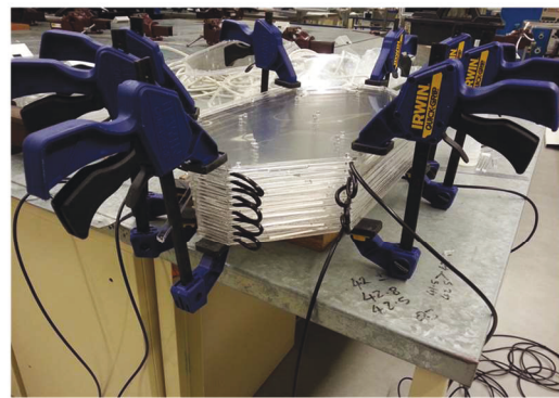
(d) Assembly of heat exchanger sub-assemblies
