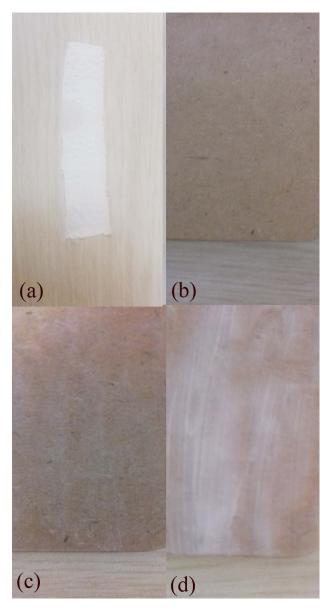
Fig. 8. UL 94 test of the (a) CA-Mg(OH)<sub>2</sub> nanocomposite (b) pristine wood (c) wood-Mg(OH)<sub>2</sub> nanocomposite (d) wood-Al(OH)<sub>3</sub> nanocomposite
