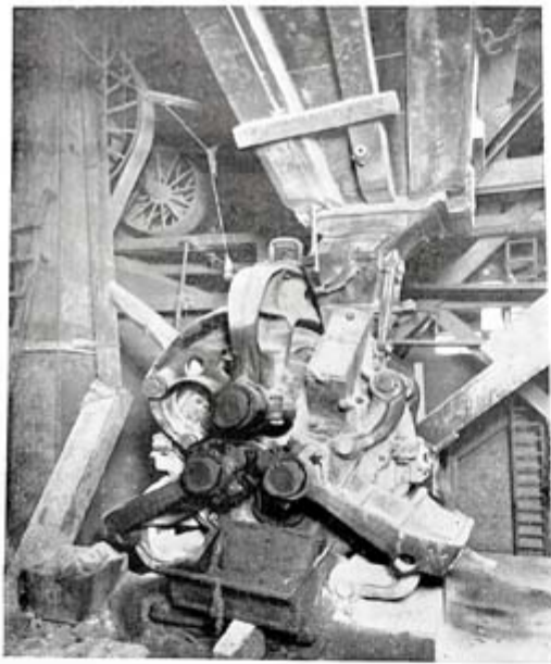
Fig. 2.—Maxecon-Kent Ring Roll Mill
