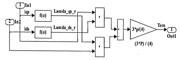
FIG.8.5(H): TORQUE CALCULATOR
