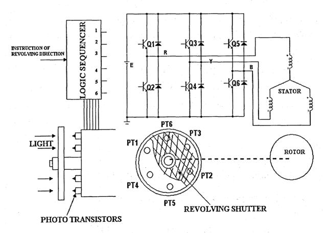
FIG.8.1: THREE PHASE BRUSHLESS DC MOTOR
